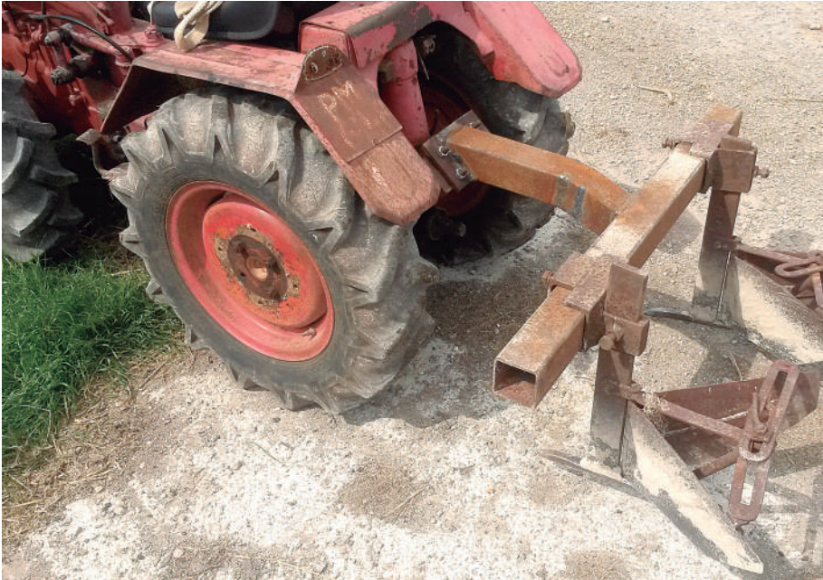
Eina per recalçar les línies de les patates. Font: Borja Camí
