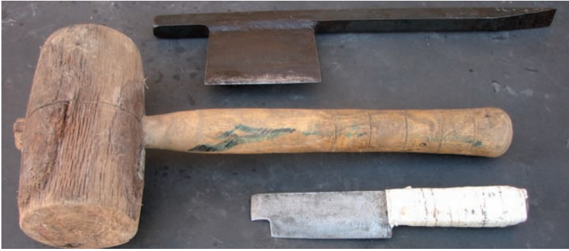
IMATGE 50. L'eina de fendre que s'utilitza en els empelts de fenedura sol estar feta pel mateix empeltador o pel ferrer del poble. Consta de dues parts, la fulla i el mànec que acaba en forma de falca per facilitar la col·locació de la muda. Dos exemples casolans d'eines de fendre i de maça per copejar.
